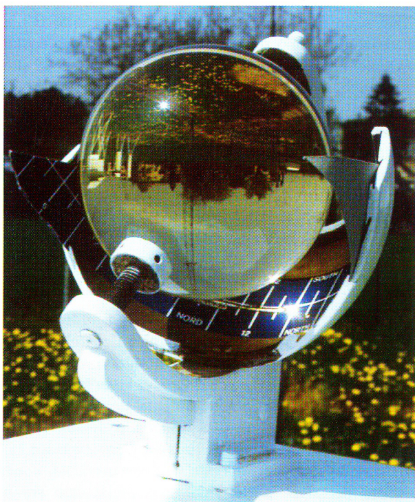
Fig. 1.- Elioanografo di Campbell-Stokes
