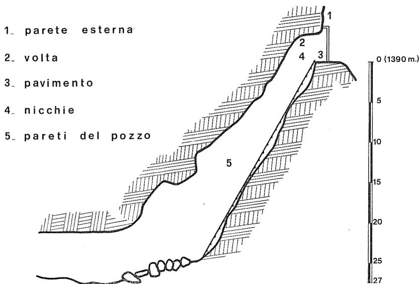
FIG. 1 - Spaccato dell'imboccatura e della voragine iniziale della Grotta di Monte Cucco. L'apertura della grotta è a m 1390, quota alla quale è stata riferita la scala della profondità. All'imboccatura sono state rappresentate schematicamente il cancello di entrata e, lungo le pareti del pozzo, la scala fissa a pioli di ferro. (Ridisegnato dal rilievo in scala 1:500 del Gruppo Speleologico del C.A.I. di Perugia).
