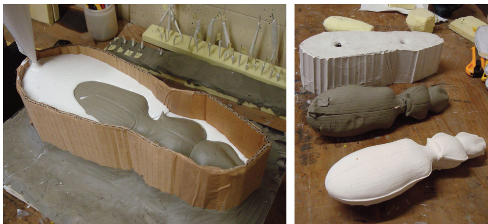
Fig. 5. Creazione delle matrici in silicone di Allegrettia comottii : a sinistra colaggio del silicone per realizzare la matrice del corpo; a destra matrice in silicone del corpo (in alto), modello in plastilina estratto dalla matrice (al centro) e calco in gesso (in basso).
