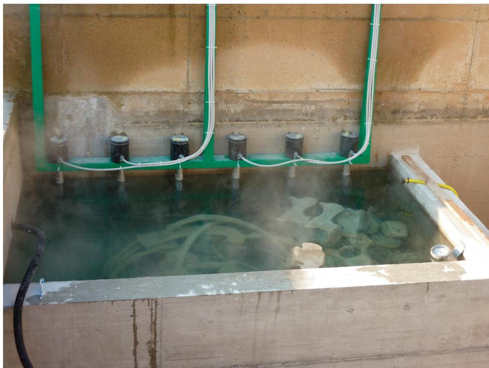
Fig. 3. Vasca in cemento predisposta per la macerazione a caldo.
